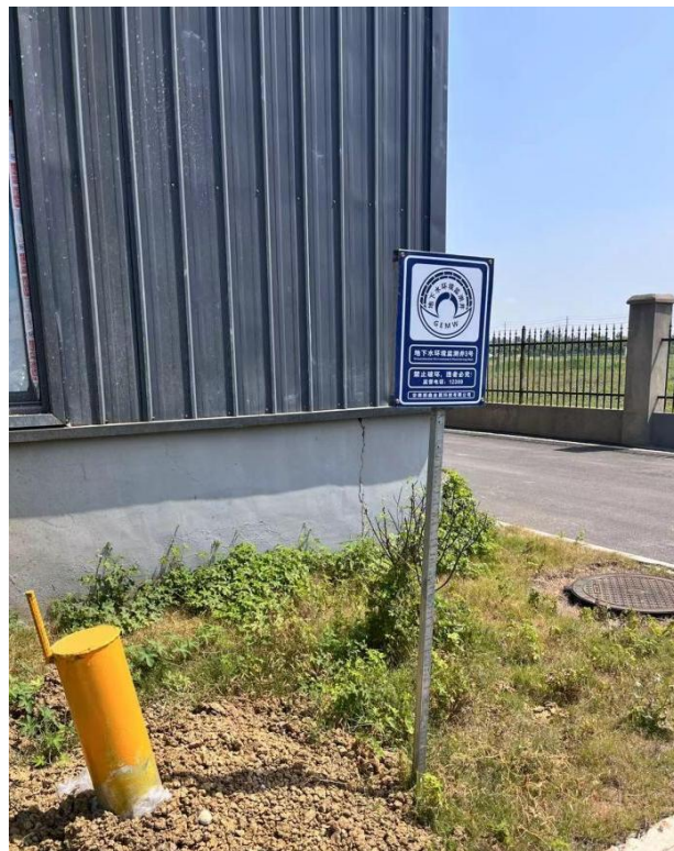
3#地下水监测井
