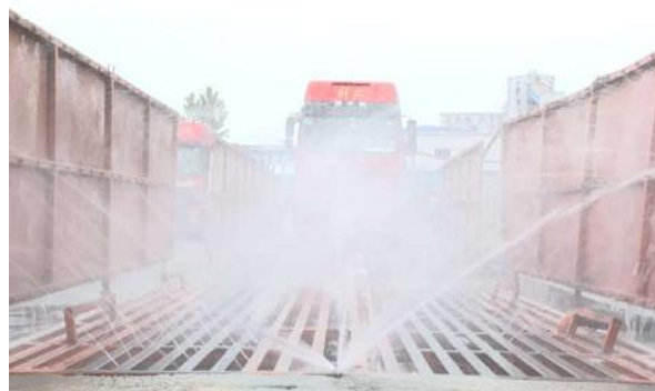
车辆冲洗平台
